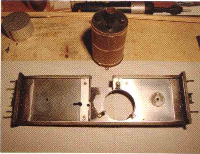
Der Lokrahmen entstand aus Aluwinkeln und -Blech. Die Aussparungen für den Keramikbrenner und die Maschine sind angebracht.
