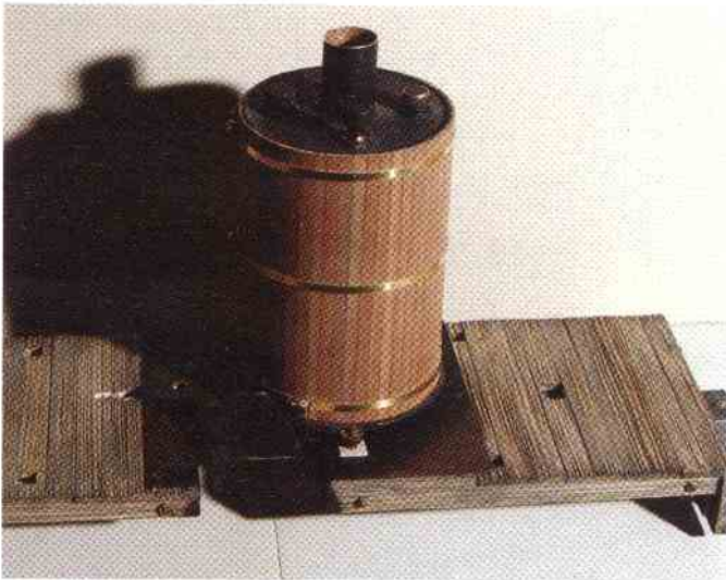
Das Metallgestell ist mit gebürstetem und gealtertem Holz verkleidet. Rund um den Boiler Ms-Riffelblech.
