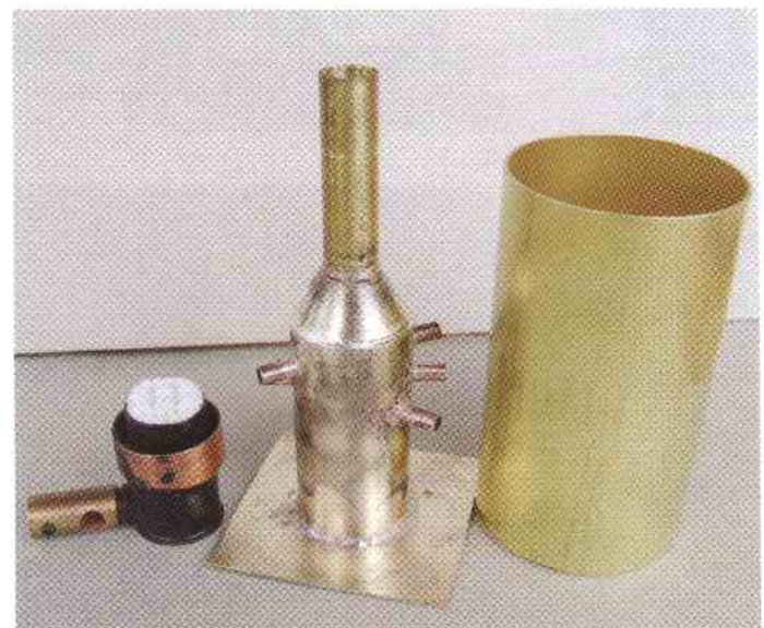
Kessel mit Keramikbrenner.
