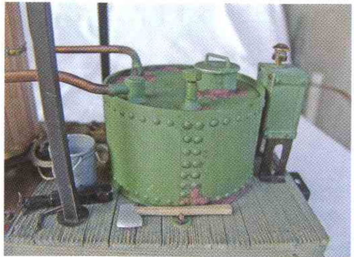
Wassertank aus Ms-Rohr.
