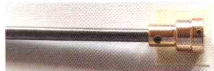
Anschluss Drehgestellwelle 6 mm Durchmesser, Bohrung 3 mm.
