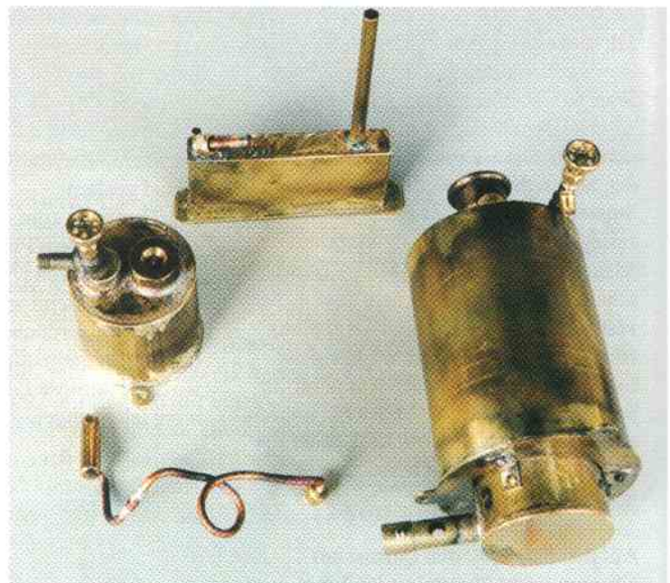
Gastank, Abdampfkondensator, Gasleitung mit Düse und Brenner.
